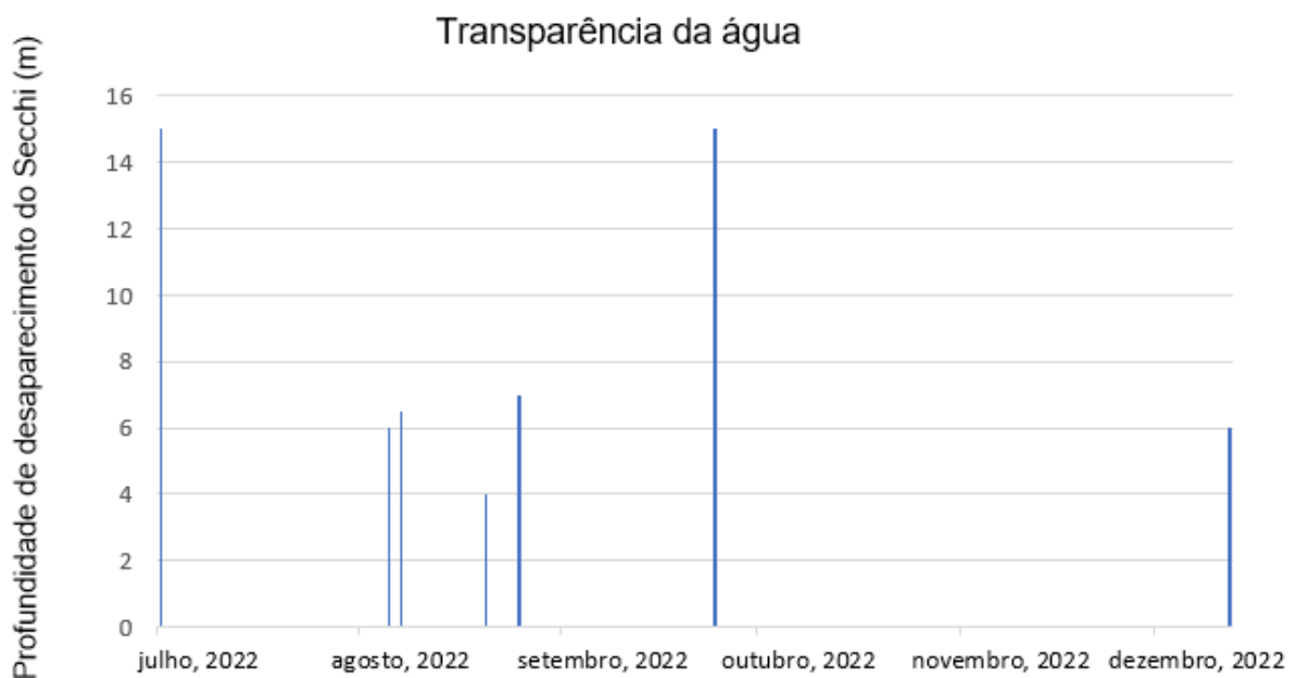
Figura 2: Profundidade do desaparecimento do disco de Secchi no ponto P12/Geladeira nas diferentes datas em que a medição foi possível.
