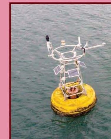
Boias oceanográficas, como a boia SP-01 do projeto SIMCosta/CEBIMar, possuem sensores que permitem o acompanhamento da temperatura, salinidade, acidez e quantidade de nutrientes, entre outras variáveis ambientais da água do mar.
